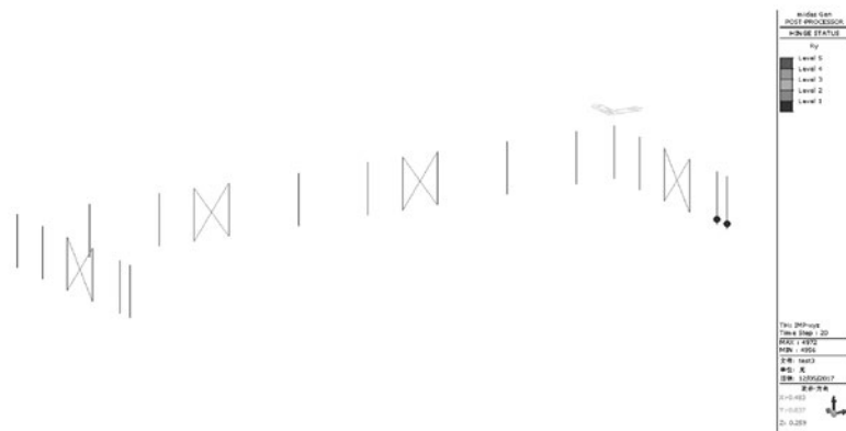
(c) 柱间支撑塑性铰分布图
